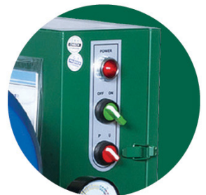
컨트롤박스 : 사용자의 동선에 맞춰서 조작스위치를 설치, 불필요한 기계조작 동작 방지
