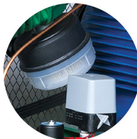
Pressure Switch : Danfoss사 의 3점점 Normal Close 타입의 고성능 사양적용
